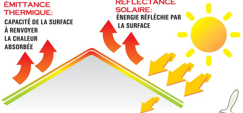
Résistance thermique : R = 0,076m<sup>2</sup> K/W - Transmission thermique: U = 0,53W/m<sup>2</sup> K - Indice de réflectance solaire SRI : 104
